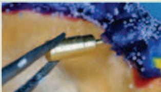
Die Positionierhilfe aus Messing herausziehen und gießen.
