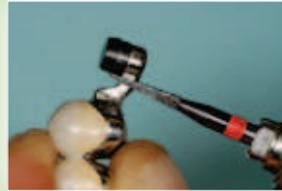
Gegossene Kronen, während des Abschleifens sollte die Kugel mit einer schwarzen Laborkappe geschützt werden, um zu vermeiden, dass sie beschädigt wird
